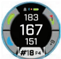
点灯した青の勾配リング - 製品が校正され、勾配が補正された距離が表示されていることを示します。
