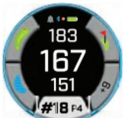
**Stetig blauer Slope-Ring** – Zeigtan, dass das Gerät kalibriert ist und Slope-kompensierte Distanzen anzeigt.
