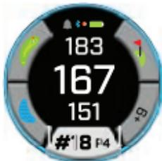
**Solid blå lutningsring** - Anger att enheten är kalibrerad och visar lutningskompenserade avstånd.
