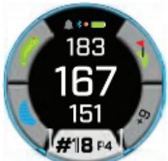
常亮 蓝色坡度环 - 表示设备已校准并显示坡度补偿距离。
