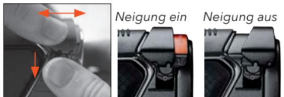
Um den Neigungsschalter ein- oder auszuschalten, ziehen Sie mit dem rechten Daumen die seitliche Verriegelung nach unten. Ziehen Sie mit der anderen Hand den Schalter auf beiden Seiten zurück, um Neigung zu aktivieren, oder schieben Sie ihn nach vorne, um Neigung zu deaktivieren.
