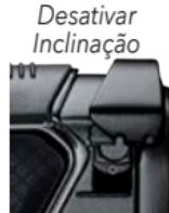
Para ativar ou desativar o comutador Slope, use o polegar direito para puxar a trava lateral para baixo. Com a outra mão, recue o interruptor nos dois lados para ativar o Slope On (Inclinação ativada), ou deslize para frente para desligar a Slope.
