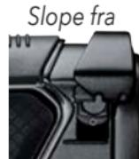
For at slå Slope-kontakten til eller fra skal du bruge højre tommelfinger til at trække ned i sidelåsen. Med den anden hånd skal du trække kontakten tilbage på begge sider for at aktivere Slope eller fremad for at deaktivere den.
