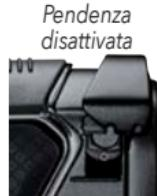
Per attivare o disattivare l'interruttore Pendenza, utilizzare il pollice destro per abbassare il fermo laterale. Con l'altra mano, tirare indietro l'interruttore su entrambi i lati per abilitare la funzione Pendenza attivata, oppure farlo scorrere in avanti per la Pendenza disattivata.
