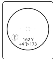
bouton POWER, une mesure d'angle en degrés et une distance compensée sont affichées sous la distance standard représenté ci-dessous. Dans cet exemple, la distance réelle est de 162 verges (148 mètres), la pente de +4 degrés et la distance compensée de 173 verges (158 mètres). Le symbole "▷" signifie "jouer comme". Par conséquent, au lieu de jouer comme 162 verges (148 mètres), "jouer comme" 173 verges (158 mètres).
