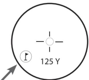
vous pouvez déplacer l'instrument lentement d'un objet à un autre et forcer ainsi le rayonnement laser à toucher plusieurs objets pour vérifier que la seule distance des objets les plus proches reconnus par le rayonnement est affichée.
